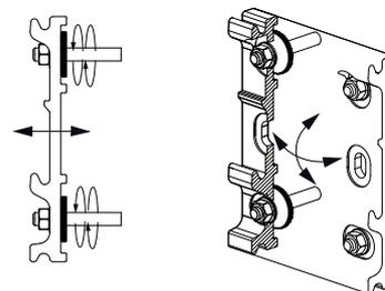
Flasque de réglage pour le montage précis des consoles
